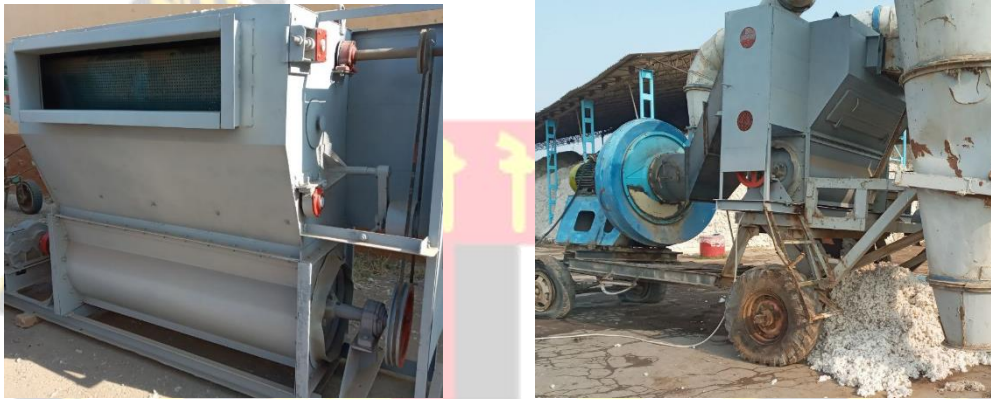
1-rasm. Yangi separator qurilmasi va uni ko'chma pnevmotransport tizimiga joriy qilingan holati.
